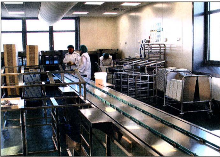
DIE SPEISENVERTEILUNG ERFOLGT auf einem zehn Meter langen Verteilerband.
