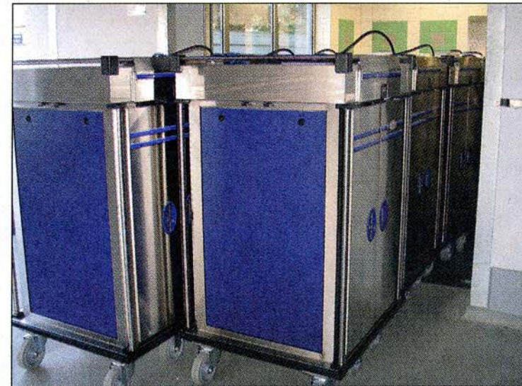
DIE PORTIONIERTEN SPEISEN WERDEN zum Transport in Verteilwagen gelagert und am Verpflegungsort in diesen fertig gegart. Fotos: Daniela Müller
