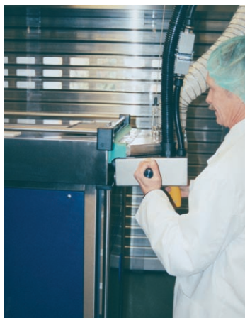
Kühler Speisentransport mit Snowline: Wolfgang Platz von Electro calorique demonstriert das Befüllen mit CO 2 .
