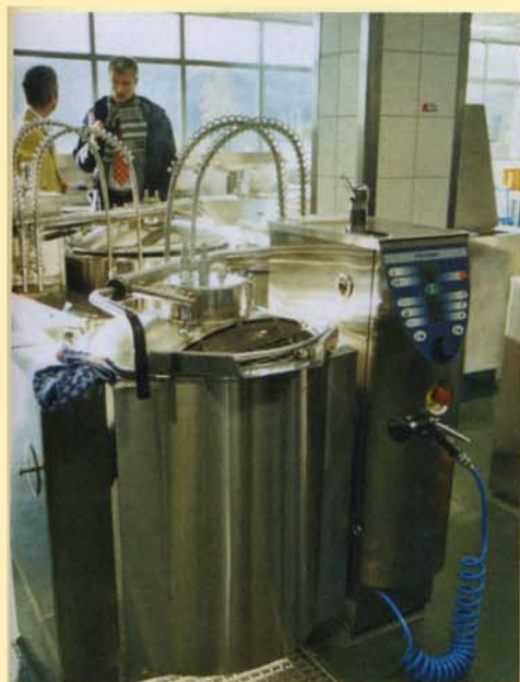
Zum Einsatz kommen die neuesten Rührkessel mit Rückkühlung von Metos/ Stierlen.
